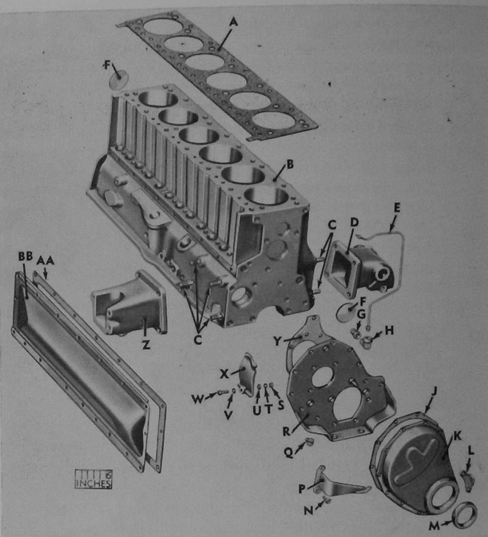
A-CYLINDER HEAD GASKET-7411605 B-CYLINDER BLOCK ASSY-YT-2194198
