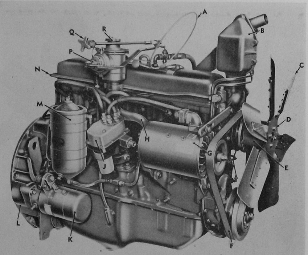
A-HAND CHOKE CONTROL ASSY-8726096 B-OIL COOLER HOUSING W/STUDS ASSY-8726922
